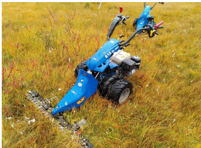
Figur 10. Tohjuls-slåmaskin med påmontert tvillinghjul. (Foto: Lea Hoch, 2020).
